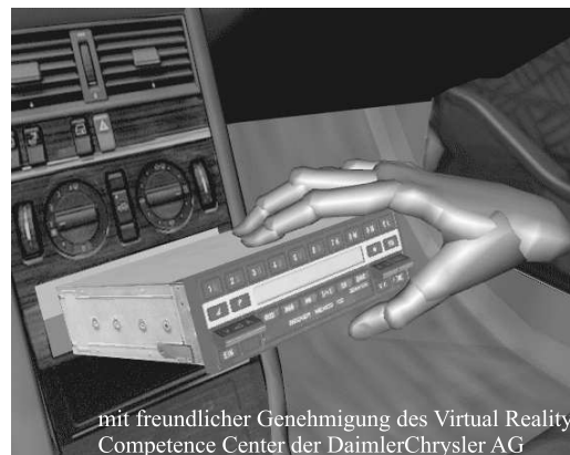
Abbildung 1.3 Das Wechseln einer Glühbirne (links) und der Einbau eines Autoradios (rechts) bei einem Mercedes in einer Virtual Reality Umgebung.
